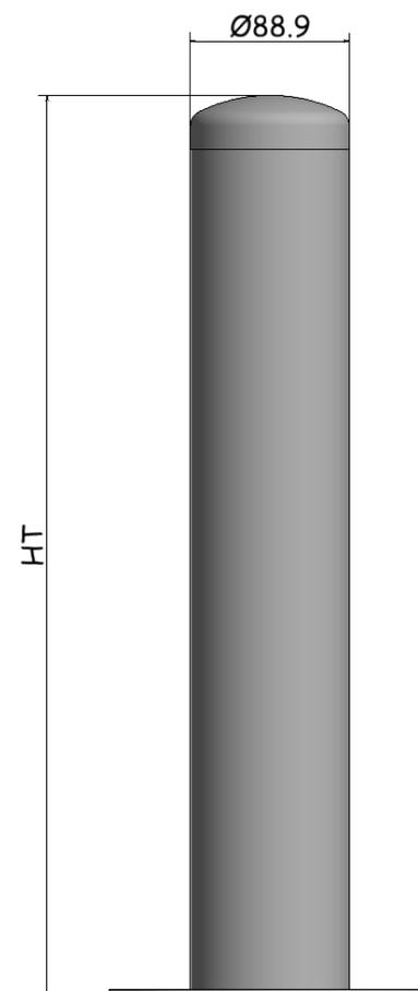
Modèle représenté : Protection tubulaire verticale 500mm - INOX
